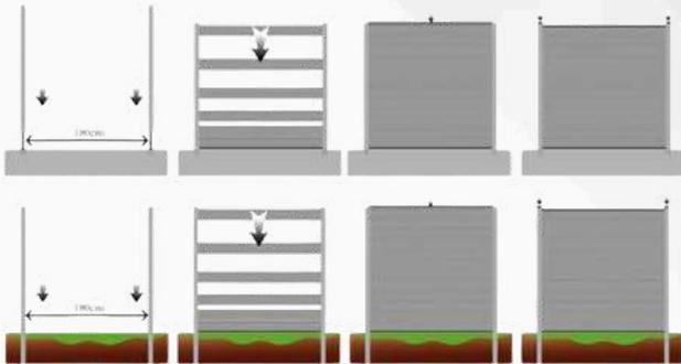
Se requiere bases de cemento, a la cual instalamos bases (o perfiles) de fierro y sobreponemos los postes de WPC. Luego colocamos entre 2 postes (a 1,894 m de distancia) el "Riel inferior", rellenos con las tablas de WPC y colocamos "Riel superior". Finalmente encajamos las Tapas de WPC sobre los postes.
