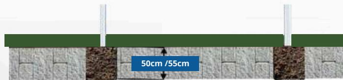
**Opción sobre radier:** Se requieren bases de cemento (altura de 1,5 m, base cuadrada de 15 cm) el eje de cada base debe estar a 1,895 m del otro. Sobre el eje atornillamos las "bases de fierro" con pernos de anclaje de 1/2 o pernos tirafondo, cuidando que queden en posición de 90°, y perfectamente alineadas una con la otra, para luego encajar el resto del SET.
