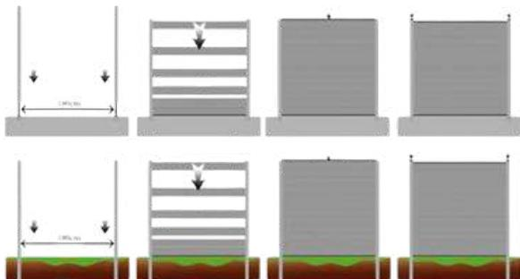
Se requiere bases de cemento, a la cual instalamos bases (o perfiles) de hierro y sobreponemos los postes de WPC. Luego colocamos entre 2 postes (a 1,894 m de distancia) el "Riel inferior", rellenamos con las tablas de WPC y colocamos "Riel superior". Finalmente encajamos las Tapas de WPC sobre los postes.
