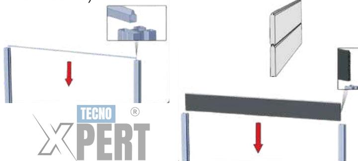
Deslizamos las Tablas para Cierres de WPC una por una hasta llegar a la altura buscada, para 2 metros necesitarás 10 tablas. Para 1,8 metros, necesitarás 9 tablas.
