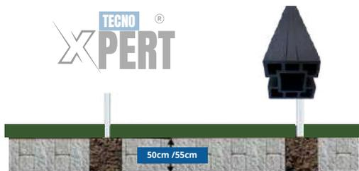
**Opción sobre tierra:** Enterrar un perfil de hierro 50 cm bajo la tierra, asegurándolo con un poyo de hormigón. El perfil es de 40\*40\*3mm y 2 m de largo, velando que la altura superficial sea de mínimo 1,5 metros. Este tiene que estar perfectamente nivelado con el próximo perfil, y a 1,895 m de distancia.
